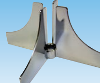
HS604 (翼径:d=105mm) 槽内均一分散性能に優れたボトムパドル翼。固一液系攪拌及びスラリー攪拌に最適で槽底部設置により液面変動・均一排出に追従します。
