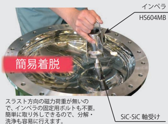
スラスト方向の磁力荷重が無いので、インペラの固定用ボルトも不要。簡単に取外しできるので、分解・洗浄も容易に行えます。
