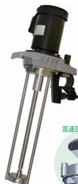
粉の塊を壊す・溶かす性能を強化したポータブルミキサーです。従来の可搬型にない特殊構造で強力な分散・溶解性能を発揮します。高速回転するロータと固定翼のステータで構成された特殊攪拌翼は、それぞれに備わった4枚ブレードにより高い剪断作用を生み出します。分級プロセスの前処理としての使用も効果的です。
