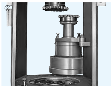
②ベアリングユニットを回転移動させる。
